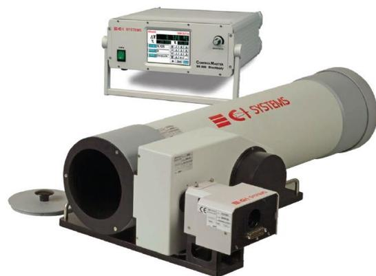
赤外線カメラの性能評価試験に最適なさまざまなタイプのコリメータをラインナップ
