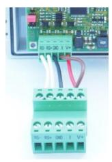
LiYCY 3 x 1.5 mm² などの単線または 1.5 mm²の撚り線で最大 2.5 mm²の断面積を持つケーブルは、付属のアダプタプラグを介して接続できます。
