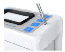
TRANSMITTER EVO の片側を開きます。マイナスドライバをスロットに挿入し、ドライバを外側に回します。カバーはヒンジで左または右に開くことができます。
