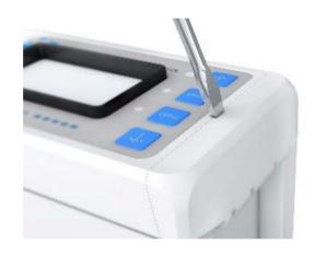
マイナスドライバをスロットに挿入し、ドライバを外側に回します。
