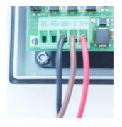
3 線式シールド接続ケーブルの仕様を推奨します。 (カバー率≥80%のシールド編組)
