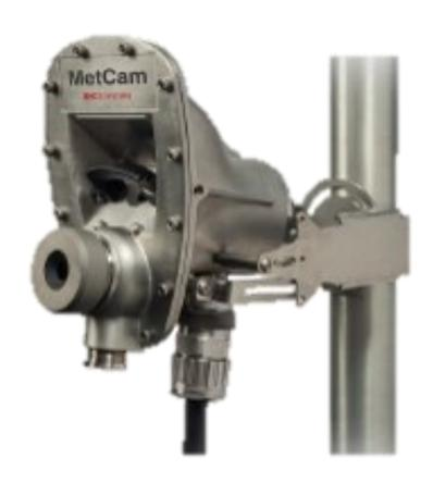
MetCamは、ガス工場、パイプライン、発電所などでの広範囲にわたるエリアにおいて連続的にメタンガスの漏洩を監視するカメラです。内蔵された赤外線カメラの映像を独自のアルゴリズムで処理することにより、メタンガス(天然ガス)を自動で検知し、事前に設定した濃度レベルに応じて即座に警報を出します。警報を出すガス濃度はユーザが設定可能です。
