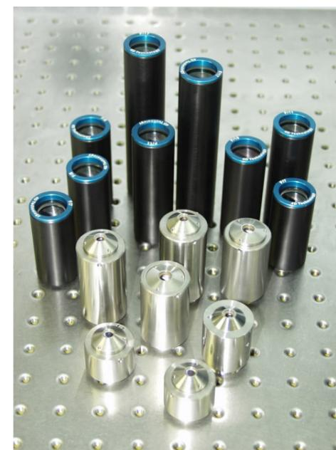
Twyman=Green干渉法で利用するDiverging Lens群も各波長帯に合わせて様々なラインナップが存在する。
