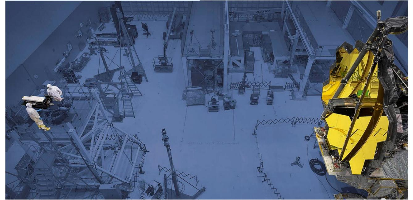
上↑ NASA-JWSTの主鏡(凹面)を、4D社Twyman=Green干渉計(PhaseMask方式DPSIを採用)で評価しているところ
