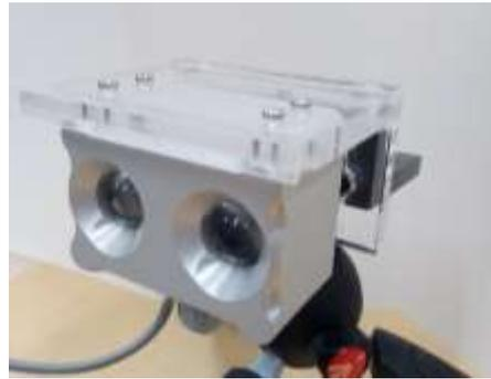
このセンサーの最も高感度なセンシティブゾーンは、センサーが設置された 25cm 前方で、このエリアにある粒子によく反応します。この粒子は霧の原因になり、視程低下の一番の要因である微小な水の粒子がほとんどですが、雪や雨、大気中に浮遊しているホコリなどにも反応します。
