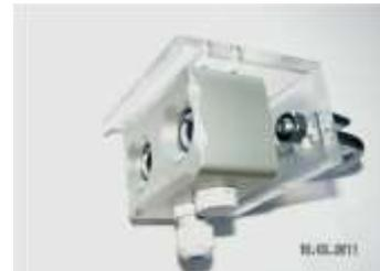
センサー外径は 68\*45\*34 mm ですが、上部に M3 規格のネジ穴が 4 つあります。納品時は上部写真にあります PMMA プラスチック製のブラケットに実装いたします。これによりセンサーは設置時電氣的に絶縁された状態でご使用いただけます。
