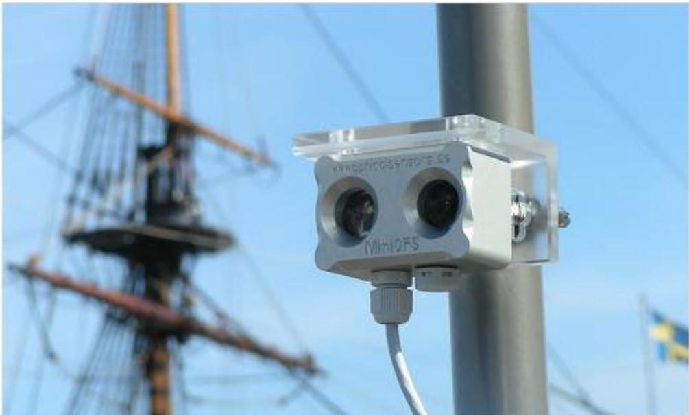
Double MiniBSV はアップデートタイムを 1 秒に設定された超小型視程計 MiniBSV を 2 台 1 組で使用する視程計です。センサーは 180 度違う方向を向くように取り付けてください。一方が太陽光などにより測定不能に陥ったとしても、もう一方が補うように視程測定を行えます。この方法により車両や船舶などに搭載しての、測定方角が常に変動するような用途でも連続測定が可能になります。
